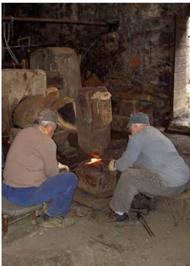
Due maiée di Bienno Valcamonica (I): il maglio è tuttora funzionante.
